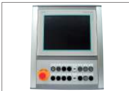
Applicazione con apparecchio di comando, listello di separazione, e pannello a due file di pulsanti
